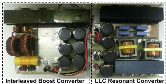
그림 10 2.2kW급 2단구성방식 DC/DC 컨버터 Fig .10 Prototype of 2.2kW two stage DC/DC converter
