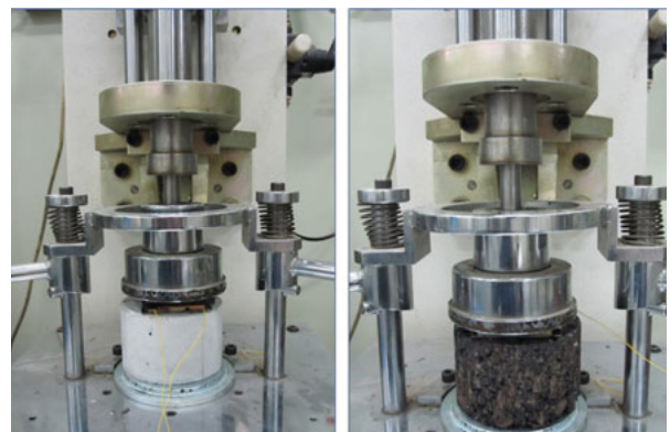
(a) 콘크리트 시편위에 압전발전 수확기(CASE I) (b) 아스팔트 시편위에 압전발전 수확기(CASE II)
