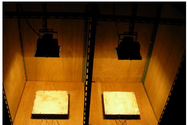
(b) 일반 및 차열 포장의 온도 변화 측정
