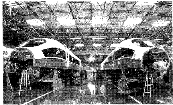
사진 1. CRH-3형 양산열차 조립광경
