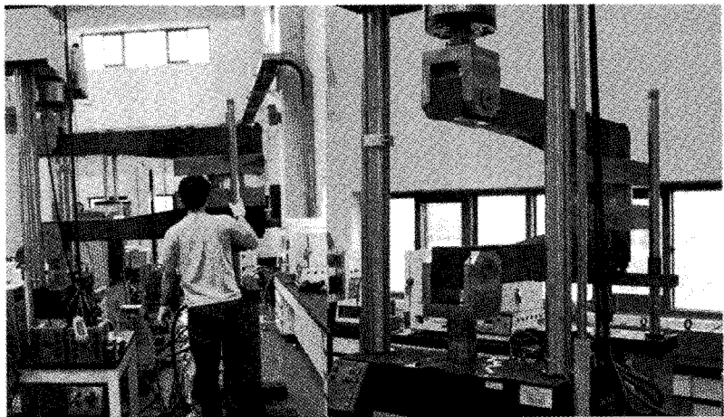
그림 5 인장실패관을 이용한 대형 배관의 파괴저항시험
