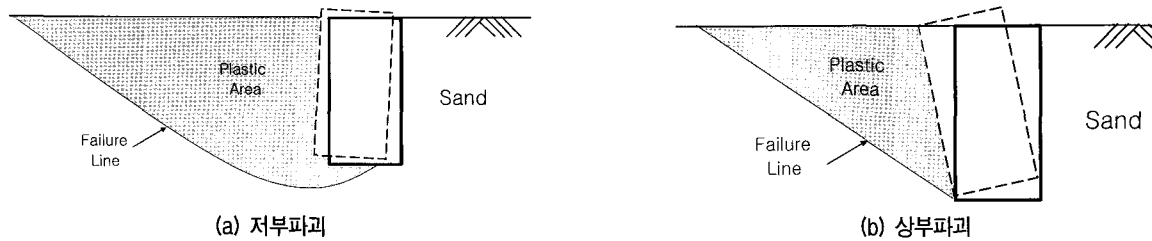
그림 11. 석션파일인발에 의한 지반파괴양상(Allersma et al., 1999)
