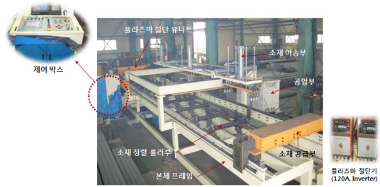
[그림 10] 철의장 가공자동화시스템
