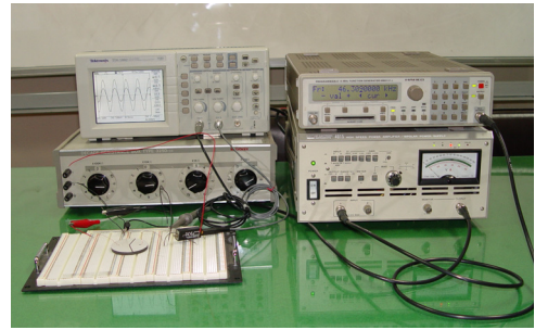
[그림 2] 압전 변압기 특성 측정 회로
