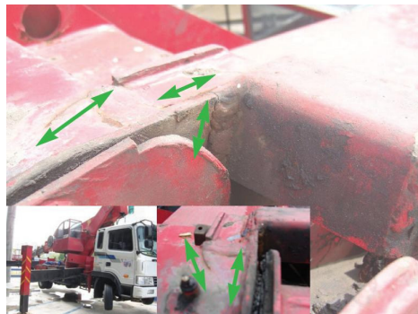
[그림 1] 응력집중으로 인한 크랙 발생
