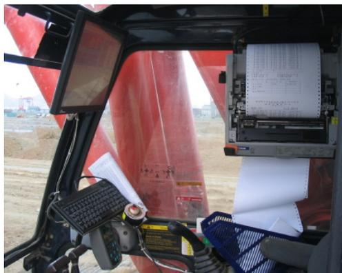
[그림 10] 측정장비가 설치된 시공장비의 운전석
