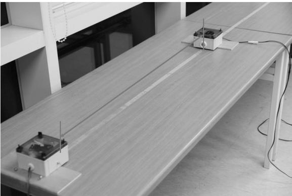
그림 5. 초음파 센서 변위 측정 검증
