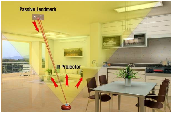
그림 2. 자기위치 인식 시스템의 개념도. Fig. 2. The schematic diagram of indoor-position recognition system.
