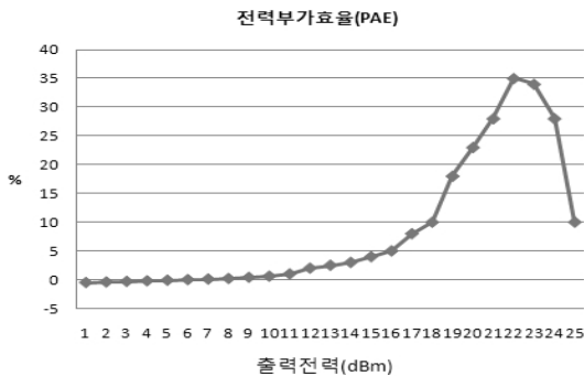
그림 7. 역 E급 주파수 체배기의 전력 부가 효율 Fig. 7. PAE of the inverse class E multiplier.
