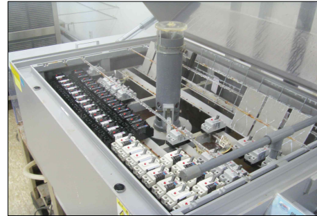
그림 1. 염수분무시험장치 Fig. 1. Salt water spray testing chamber
