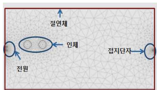
그림 7. 전위분포 모델링 - 수중, 사면 절연 내 접지단자, 인체 존재(case 6) Fig. 7. Potential distribution model - human in the water, ground terminal, insulator of 4 wall (case 6)
