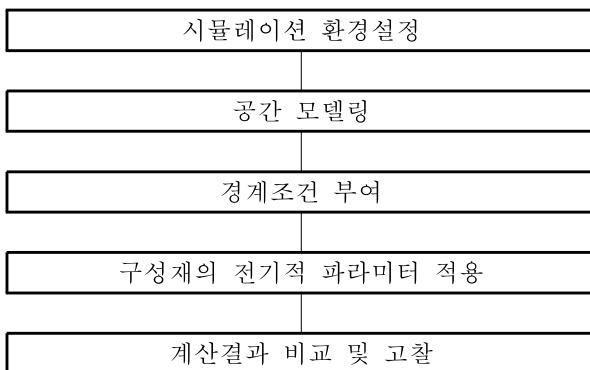
그림 1. 전위분포 해석 시뮬레이션 절차 Fig. 1. Simulation process for analyzing potential distribution
