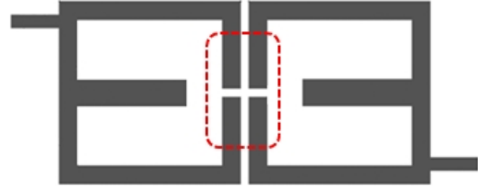
그림 3. E 형태의 이중 모드 공진기를 이용한 필터의 구조 Fig. 3. The structure of the filter using E-shaped dual-mode resonator.
