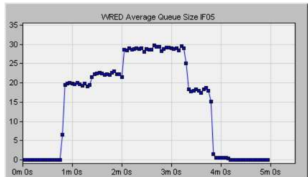
그림 10. WRED 평균 큐 크기 (per flow QoS) Fig. 10. WRED average queue size (per flow QoS).
