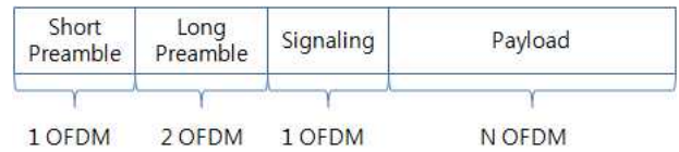
그림 1. WLAN 전송 프레임 구조 Fig. 1. WLAN Frame Structure.
