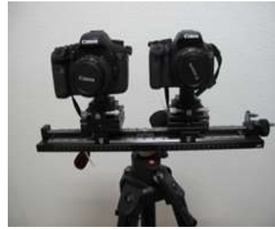
그림 1. 입체 카메라 실험장치 Fig. 1. Experimental set of stereoscopic camera
