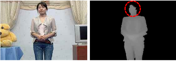
그림 4. 머리카락 영역의 깊이 값 손실 Fig. 4. Depth acquisition failure at hair region.
