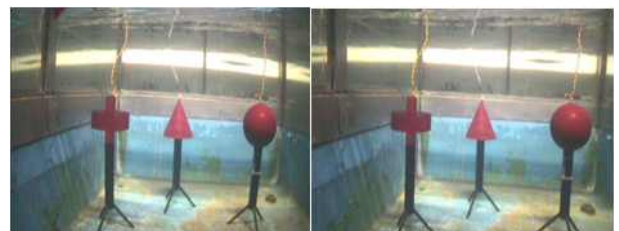
그림 1. 왜곡된 영상(좌)과 보정후의 영상(우) Fig. 1. A distorted image(left) and the corresponding undistorted image.
