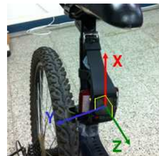
그림 1. 가속도의 측정과 무선 송신을 위해 부착된 EZ430-Chronos kit
