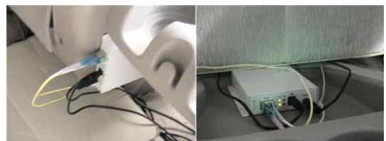
그림 20. 자동차 실내에 장착된 음성 게이트웨이 Fig. 20. The audio gateway installed within a car.
