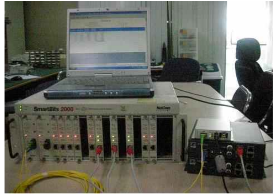
그림 16. Smartbit2000 기반 성능분석시스템 Fig. 16. The performance analysis system with Smartbit2000.
