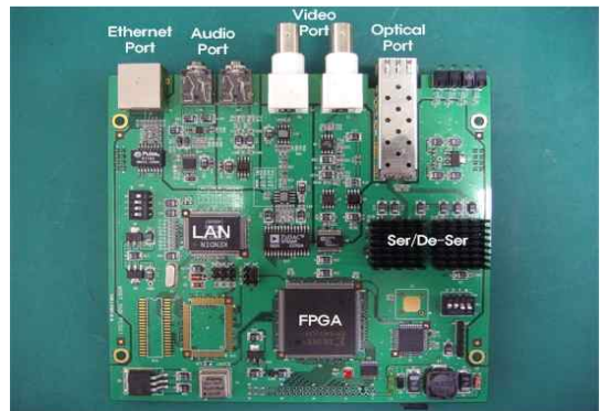
그림 6. 개발된 일체형 게이트웨이 Fig. 6. The one board gateway.
