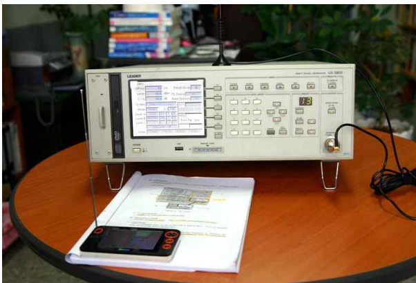
그림 7. 시제품의 수신 성능 시험 Fig. 7. Receive functional test.
