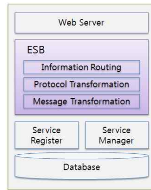
그림 3. 서비스 중계자 컴포넌트 구조 Fig. 3. Component architecture of service broker.
