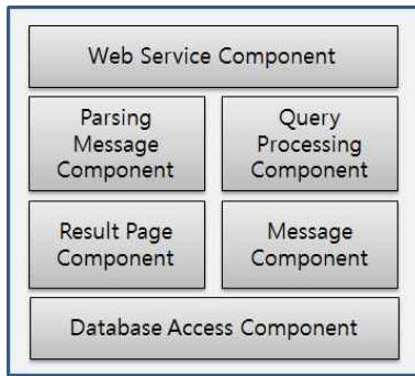
그림 2. 서비스 제공자 컴포넌트 구조 Fig. 2. Component architecture of service provider.
