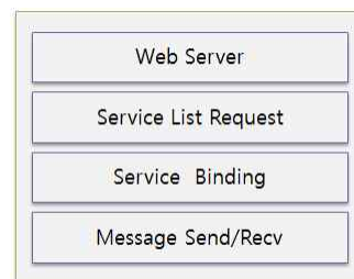
그림 4. 서비스 소비자 컴포넌트 구조 Fig. 4. Component architecture of service consumer.
