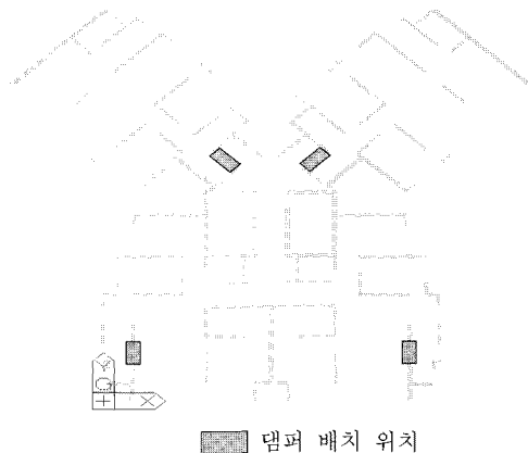
(b) 구조물 평면도 및 제진댐퍼 배치도
