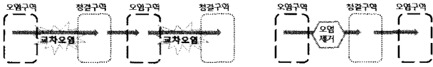
<그림 18> 고객 동선이 오염구역-청결구역-오염구역-청결구역으로 반복되면 교차오염 가능성이 커진다. 오염구역-청결구역-오염구역 순서로 동선을 계획한다. 청결구역으로 가기 전 오염이 제거되지 않으면 교차오염 가능성이 높아지므로 청결구역으로 가기 전 위치에 오염제거시설을 배치하여 교차오염을 방지한다.
