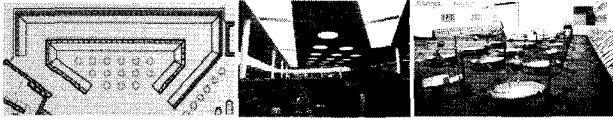
<그림 10> 볼프스부르크 문화센터 도서관의 천창 배치를 보여주는 지붕평면, 선형 천창과 원형 천창, 열람실 지붕의 원형 천창군
