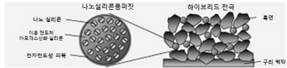
Fig. 16. Hitachi Maxell이 개발한 Si 음극구조 [31]
