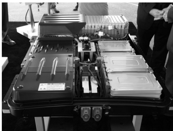
Fig. 2. Nissan LEAF에 탑재된 리튬이온 이차전지 팩 [6]
