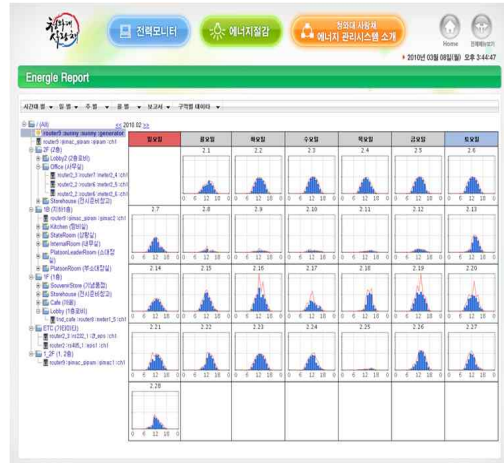
그림 24. 실제건물에 적용한 DER static DB와 Historical DB 운영자 화면 예 Fig. 24. Operation user interface of DER static DB and Historical DB
