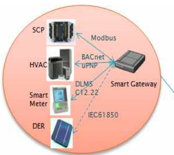
그림 1. 수용가 노드 프로토콜 변환 Fig. 1. Consumer Node Protocol Conversion
