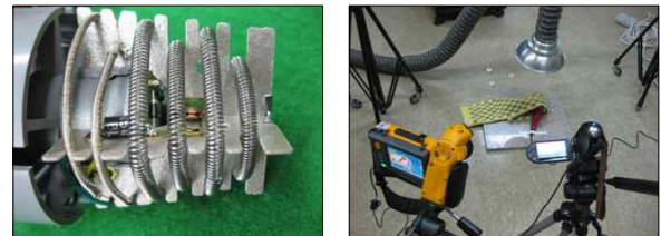
(a) 구속된 바이메탈 스위치 (b) 실험 장치
