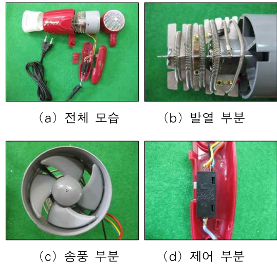
그림 1. 모발건조기의 구조 Fig. 1. Structure of Hair Dryer
