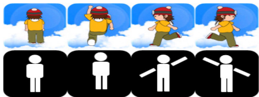
그림 4. 사용자 제스처 정의. 정면 자세는 '정지', 양손을 동작에 의해 좌우 방향 전환이 가능하다.
