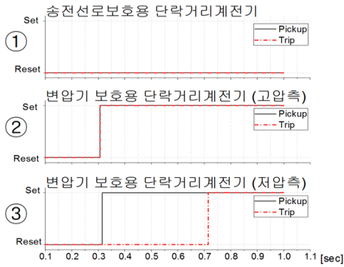
그림 15 사례 1의 계전기 동작결과 Fig. 15 Operating results of relays for case 1
