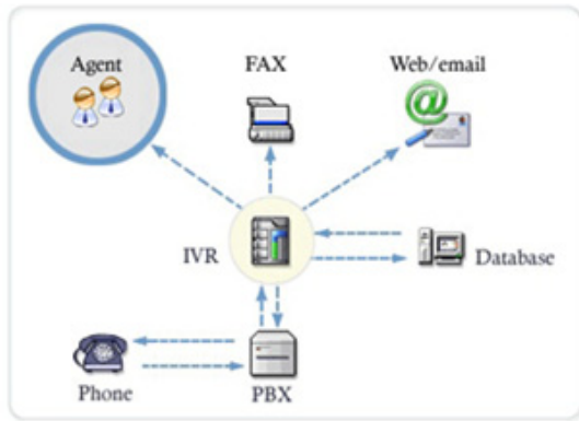
그림 1. ARS 구조 Fig. 1 The structure of an IVR system
