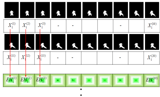
그림 4. 실루엣 영상에서의 에지 방향성 히스토그램 추출 및 DB구성 Fig. 4 Extraction of EOF in Silhouette image and DB configuration
