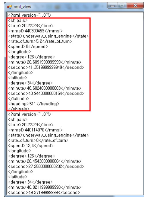
그림 9. AIS 정보 XML변환 Fig. 9 Change AIS Information to XML
