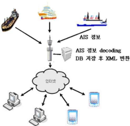
그림 6. 선박위치정보 서비스의 구조 Fig. 6 Structure of Vessel Positional Information Service
