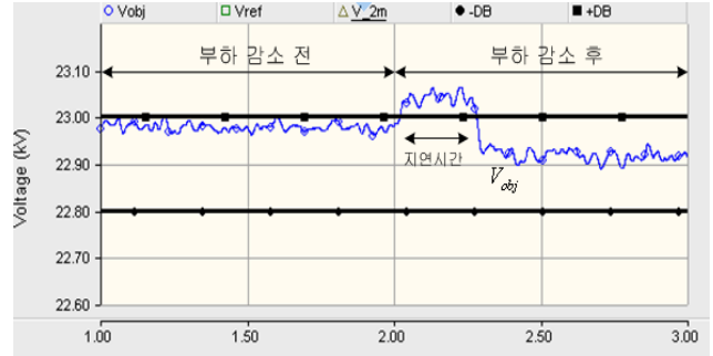
그림 14 제안된 ULTC 전압제어 방식에서의 V_{obj} 그래프 : 사례4 Fig. 14 V_{obj} in proposed ULTC voltage control : Case 4
