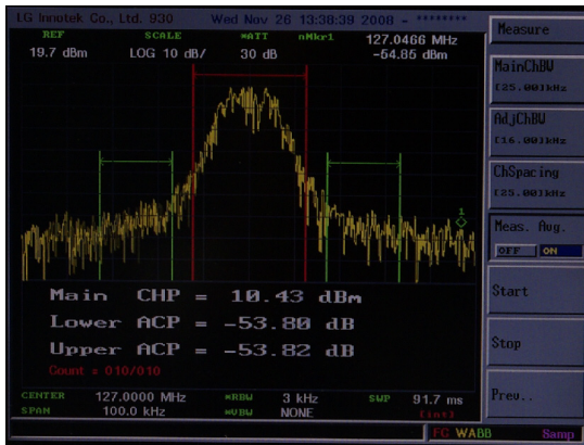
그림 10. 첫 번째 인접채널 16kHz 대역 Fig. 10 1st Adjacent Channel 16kHz Bandwidth
