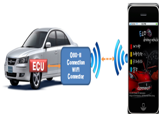
그림 2. 진단 시스템 구성도 Fig. 2 Diagnostic System Configuration
