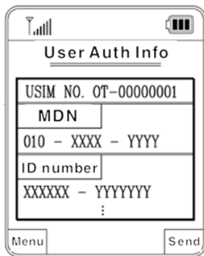
그림 1. 유동적 USIM 카드를 이용한 가입자 인증시의 필수 전달인자 Fig. 1 Essential parameters for user authentication in the flexible USIM method
