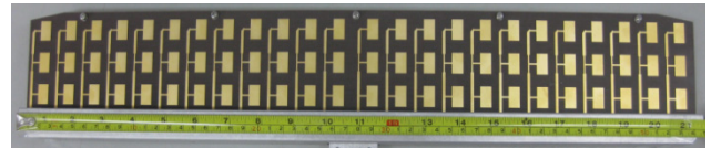
Fig. 7. Fabricated 3×24 array antenna.
