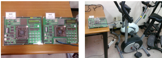
그림 7. 장치노드(사용자)와 중계노드(운동기계)의 구성 Fig. 7. Configuration of device(User) and Relay node (Bicycles machine)
