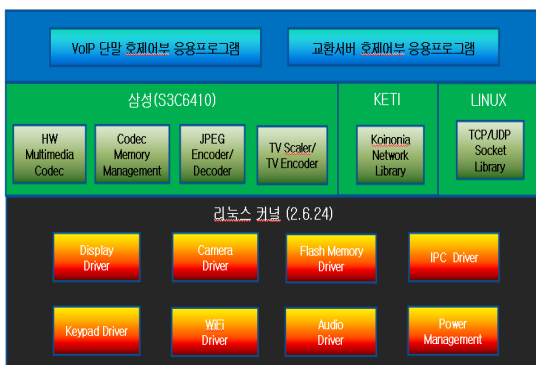
그림 6. 무선 VoIP 시스템 소프트웨어 아키텍처 Fig. 6. System Software Architecture of Wireless VoIP System
