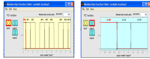
그림 4. 퍼지 제어기의 입력변수 및 x-축 출력 변수 Fig. 4 Fuzzy controller input variables and the x-axis of the output variable.
