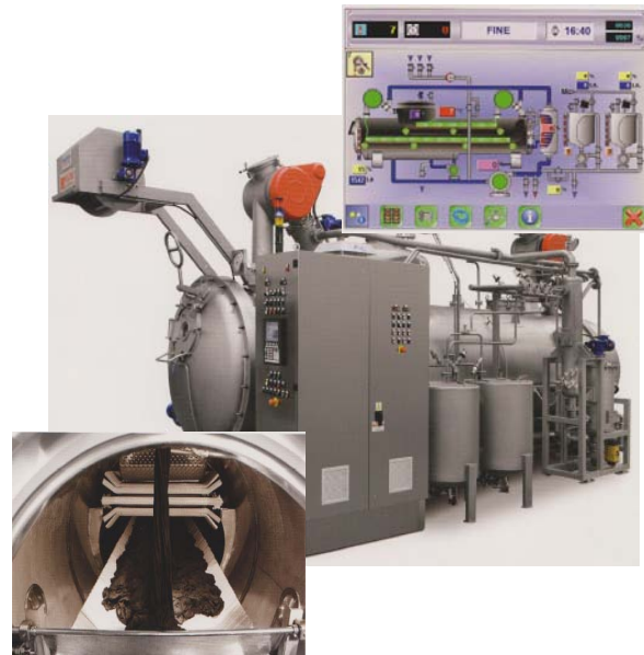
Fig. 10. BRAZZOLI의 Innotech air-flow 염색기.
