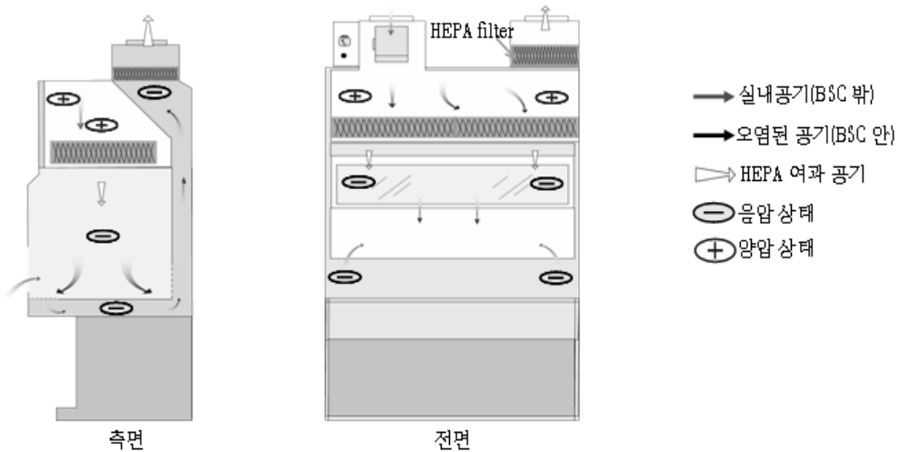
그림 10. Class II B2형 생물안전작업대
