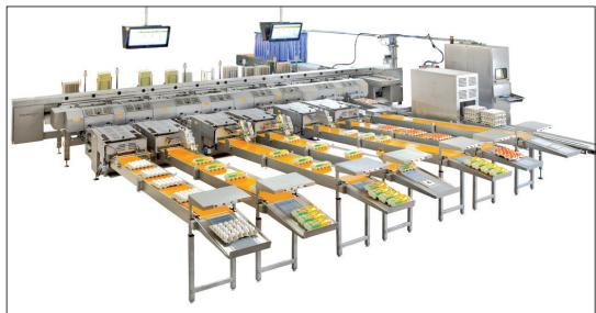
과학시스템(주)(대표 박만후)은 계란선별포장기 사노보  $\alpha$ -125를 선보인다. 시간당 9만개(2대\*45천개)의 처리능력이 있으며, 최신의 전자 및 기계 기술을 적용한 최신형이다. 작업량이 적을 때는 2대중 한 대만 사용가능하며 포장 라인수가 많아 다양한 포장 재를 사용가능하다. 계란의 위생처리가 강화되는 세 계적인 추세에 따라 오염이 쉬운 공급라인, 계근의 위생처리가 강화되는 세계적인 추세에 따라 오염이 쉬운 공급라인, 계근 및 파란검색시스템 등을 고압 세척기로 완전히 세척할 수 있고, 세척을 위해 별도로 분리할 필요가 없어 사용하기 용이하다. 대형 LCD 디스플레이를 사용해 각 레인의 작업상태를 멀리서도 쉽게 파악가능하며 터치 스크린식이다.
