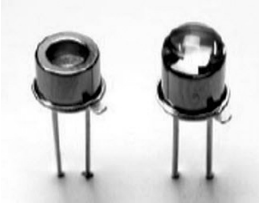
그림 6. Hamamatsusa의 infrared LED 및 radiant 측정치
