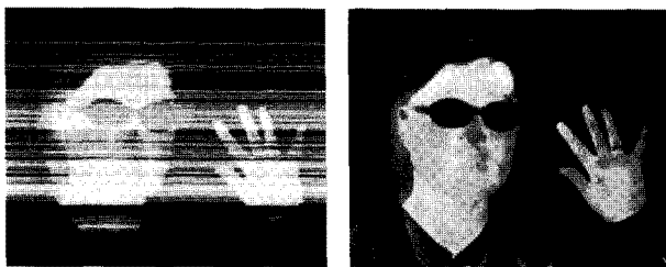
그림4. 검출기 실시간 불균일 보정 사례(원적외선, 주사방식 영상)
