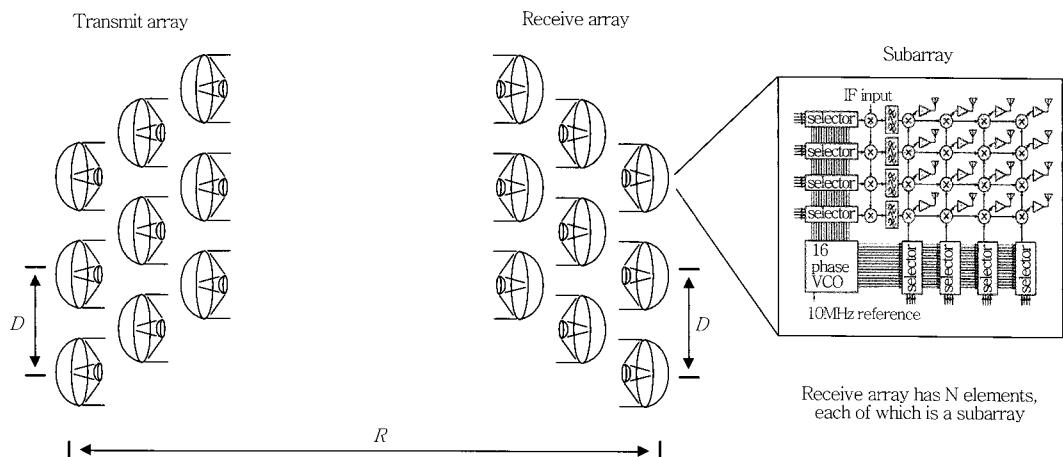
(그림 10) MIMO 기술을 이용한 40Gbps급 전송 시스템
