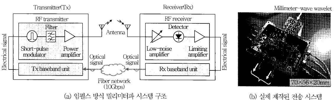
(그림 11) 임펄스 전송방식을 이용한 10Gbps급 전송시스템
